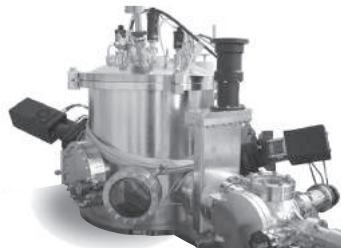
In-Situ 成膜装置取付 in-situ測定
